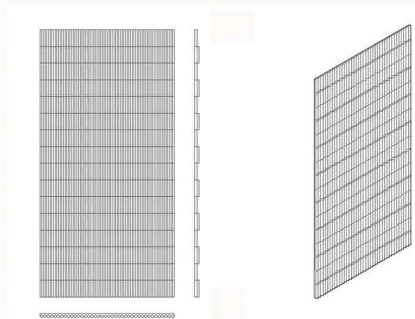
**L**a geometría de estas piezas permite lograr una continuidad visual y espacial, ya que se minimizan las juntas de unión y se plantea la sistematización de la repetición para lograr revestir áreas de mayor dimensión.
